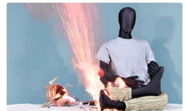
充電式掃除機のバッテリー発火事故の再現
